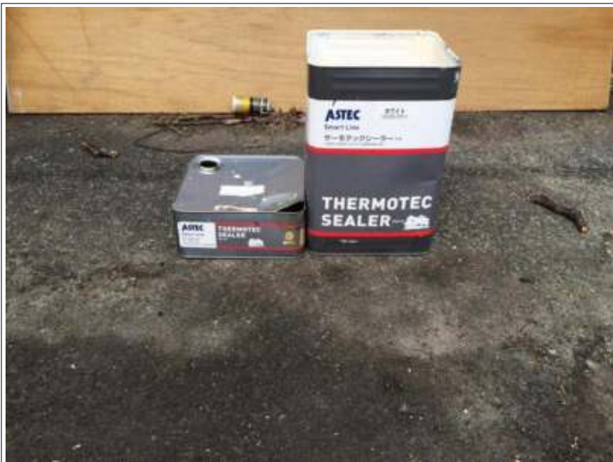
屋根 下塗り使用材料空缶
