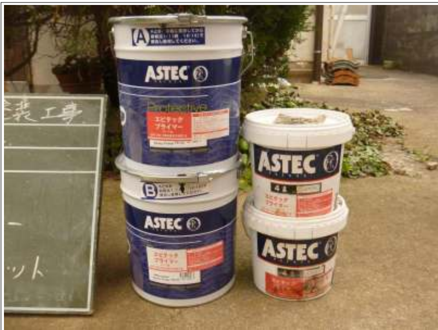
屋根下塗り使用材料
