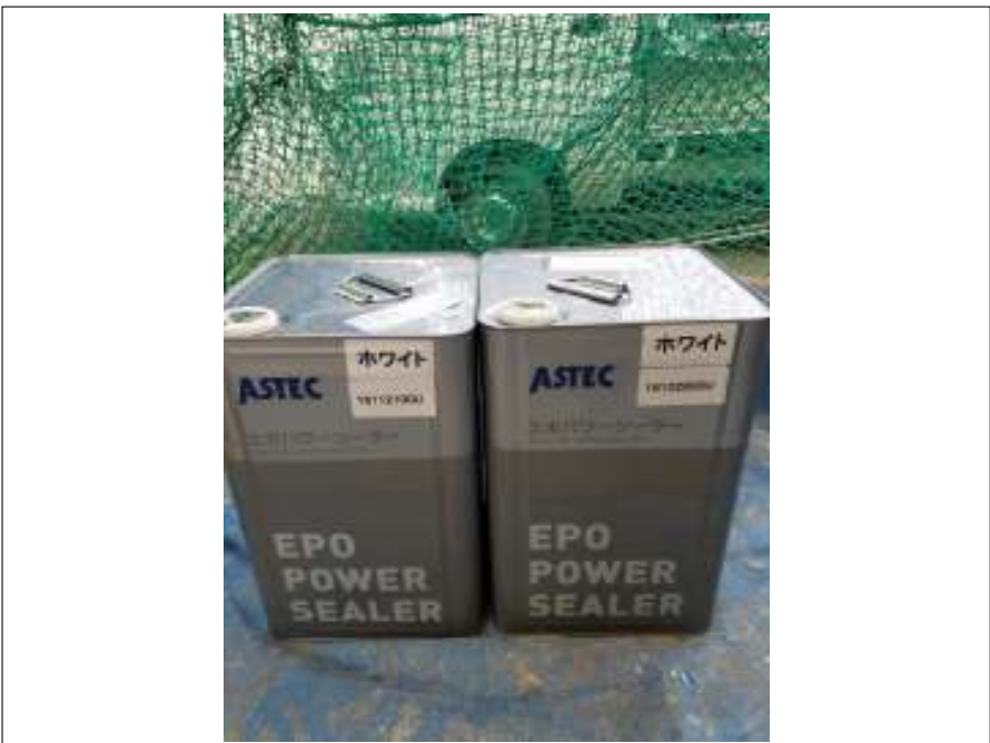
屋根 下塗り使用材料
